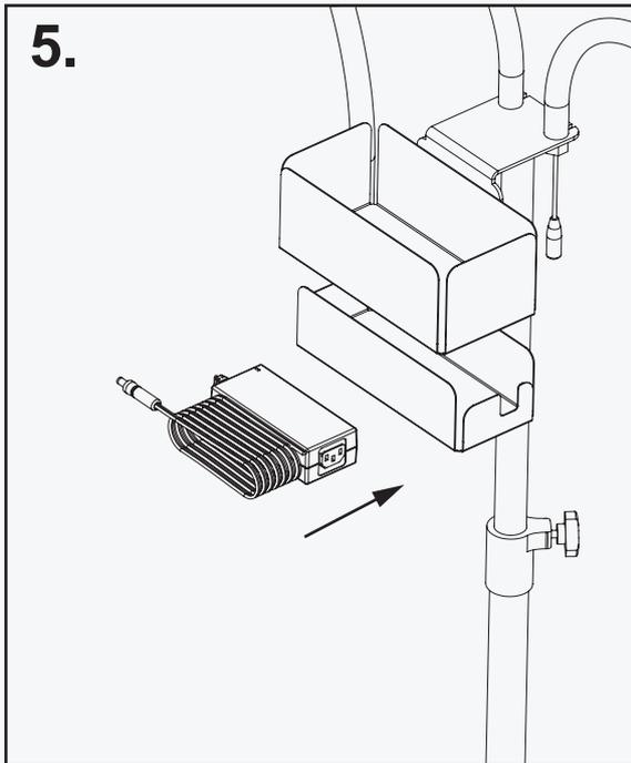
→ Positionner le bloc d'alimentation secteur dans le panier inférieur selon la photo de la fiche technique, l'encoche du panier placée en regard de la prise du câble secteur. Ranger le câble basse tension à côté du bloc d'alimentation.
