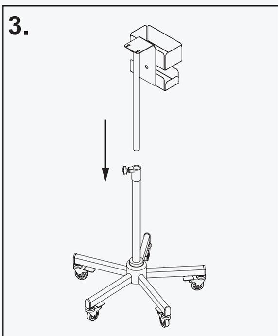
→ Enfiler le *tube panier* dans le *tube de base*
