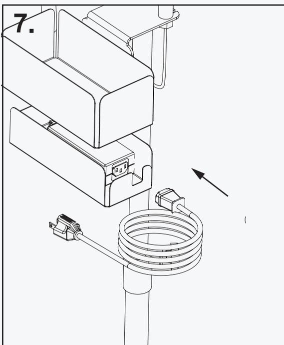
→ Connecter le doubleur de prise au câble basse tension au travers du trou de passage et connecter le câble secteur au bloc d'alimentation
