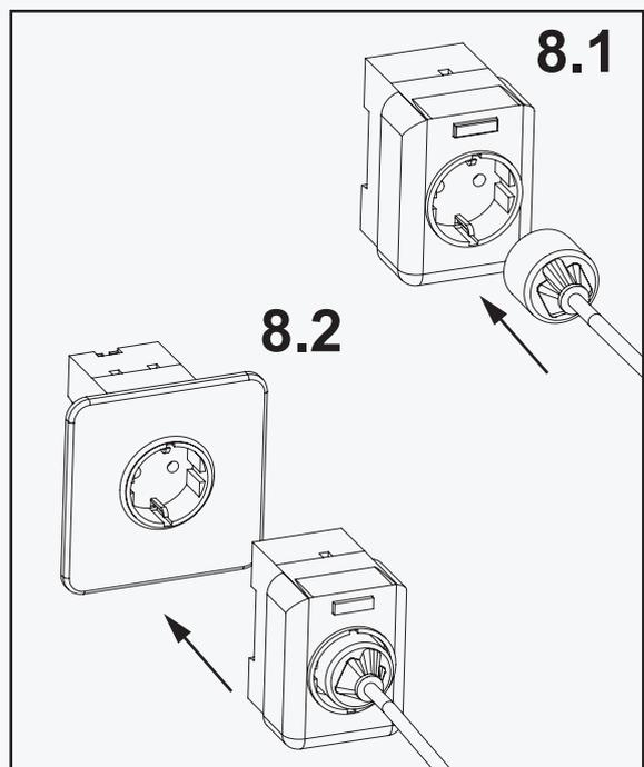
→ Connecter le câble secteur sur la prise avec interrupteur et connecter la prise interrupteur dans une prise secteur murale
