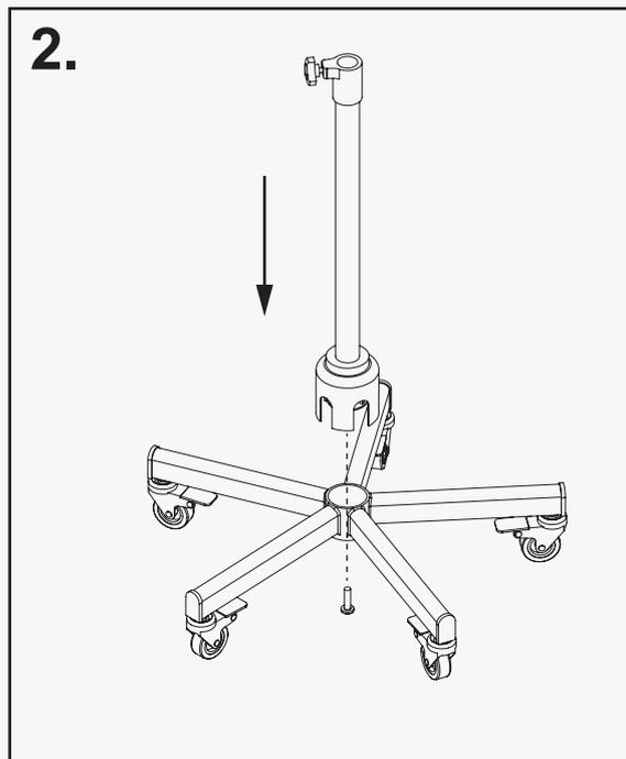
→ Visser le *tube de base* sur le *ped à roulette* grâce à la vis
